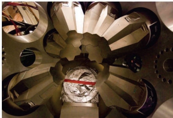
FIGURE 3.7 – Position des modules de GRETINA utilisés lors de l'expérience [41].
